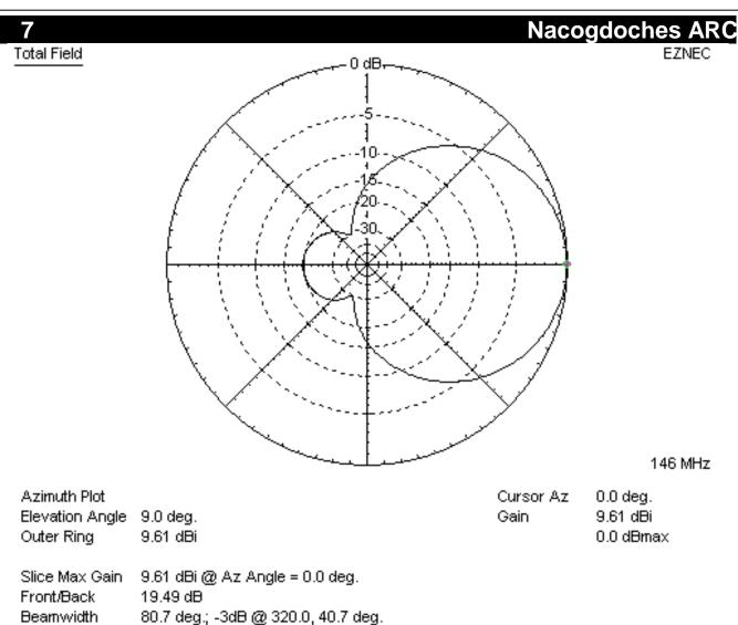
Beamwidth 80.7 deg.; -3dB @ 320.0, 40.7 deg. Sidelobe Gain -9.88 dBi @ Az Angle = 181.0 deg.
